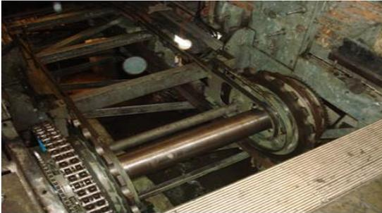
Eje principal de tracción con término de vida útil, en los dientes de las catarinas principales y secundarias, discos del freno de servicio y de emergencia.
