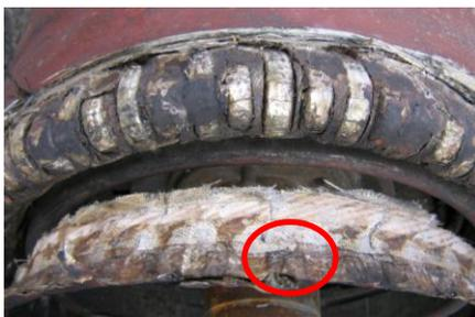
Inducido de motor de Tracción (rotor) con cincho dañado
