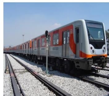
Tren de rodadura neumática de reciente adquisición
