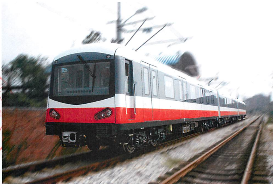
Fig 12 Carros de Metro con una velocidad de 120km/h para la Línea 3 del Metro de Guangzhou en prueba de comisión dinámica
