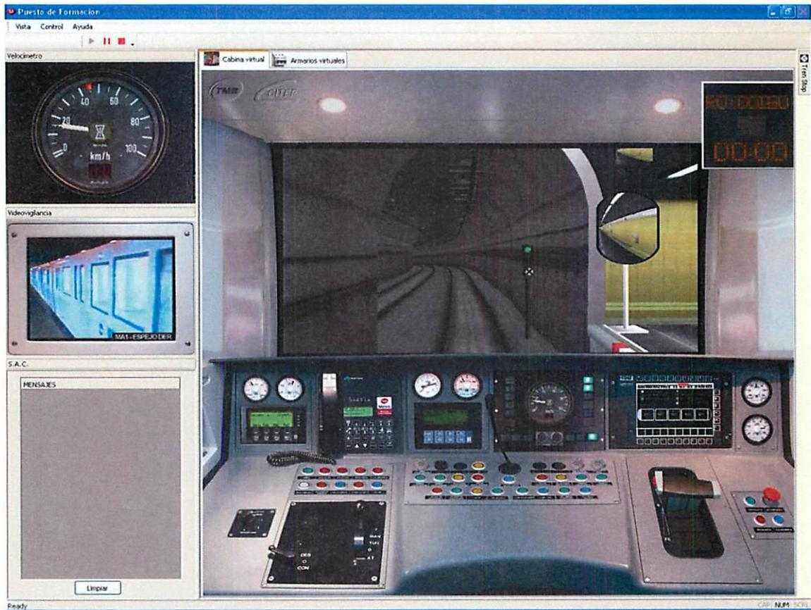
Se dispondrá de un sistema de zoom que permitirá acercar la visualización a cualquier de los subpaneles o a los elementos particulares: velocímetro, monitor de ayuda a la conducción, etc.
