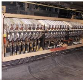
“JH” (Contactores del Sistema de Tracción Frenado)
