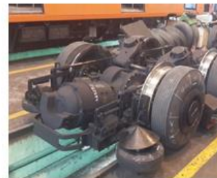
Bogie armado con refacciones nuevas
