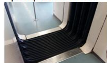
Nuevos pasillos de Intercomunicación
