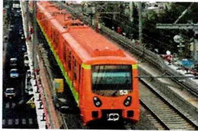
El diseño de los trenes tiene que ser para una vida útil mínima de 30 años, bajo las condiciones de servicio establecidas, y ser capaces de operar ya sea en túnel o a la intemperie, en este último caso a nivel de superficie o elevado, bajo las condiciones del medio ambiente que prevalecen en la Ciudad de México, considerando que cubrirán un recorrido aproximado de 150,000 kilómetros por tren anualmente.
