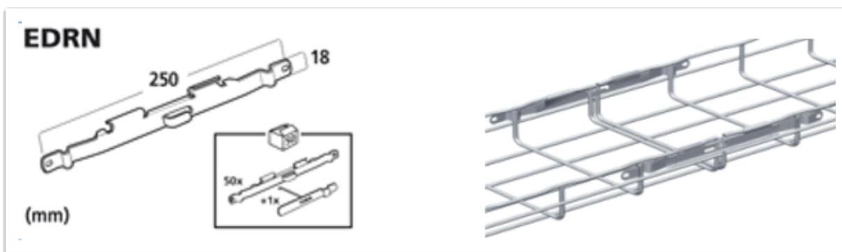
El soporte a la pared se realizó con ménsulas tipo "L" para charola de 150 mm de ancho con sistema FAS para fijación rápida de la charola sobre la ménsula para instalación a muro con acabado galvanizado por inmersión en caliente a 80 micras de zinc para uso exterior marca Cablefil.
